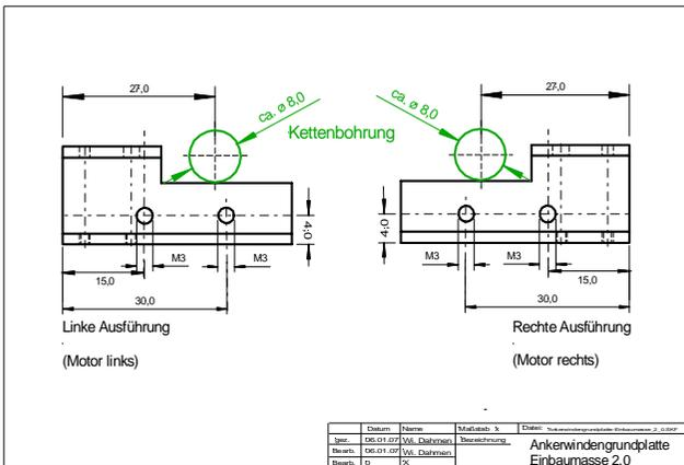
Bild: Montagebohrungen (Sicht von oben)
